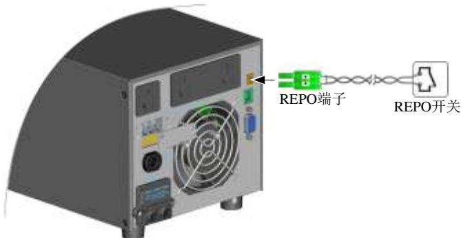
图4-1 REPO 端子接线示意图
