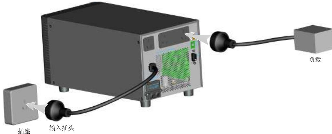
图2-1 输入电缆、负载连接图
