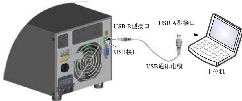
图2-6 USB 通讯电缆连接
